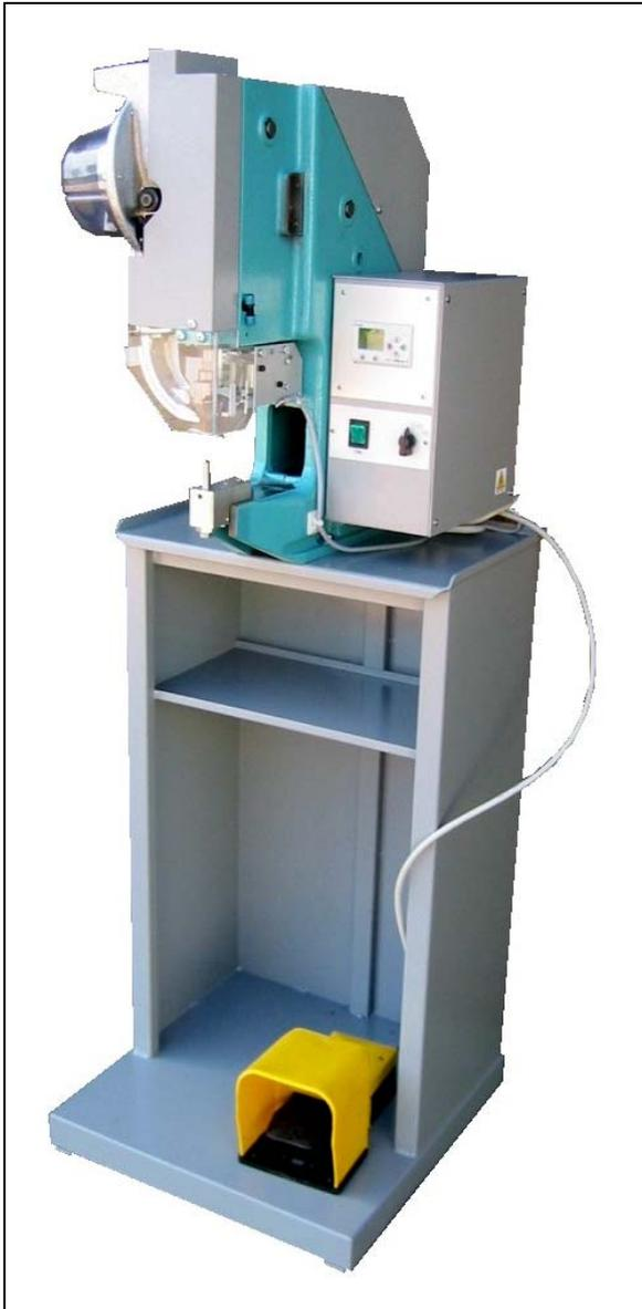
Macchina rivettatrice automatica a motore elettrico (disponibile anche in versione pneumatica Mod. M11R-P ) per l'applicazione di rivetti con diametro della testa fra 3 e 20mm. Il caricatore facilmente intercambiabile permette l'applicazione di ogni tipo di rivetto. Può esser usata come macchina semiautomatica per rivetti o bottoni jeans come pure bottoni a pressione o rivetti maschio femmina.
