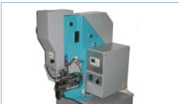
Macchina occhiellatrice perforante a doppia alimentazione per l'applicazione di occhielli con rondella (diametro gambo max 8mm). La macchina è dotata di un dispositivo di perforazione a camma con regolazione accurata e semplice per garantisce la perforazione su ogni materiale.
